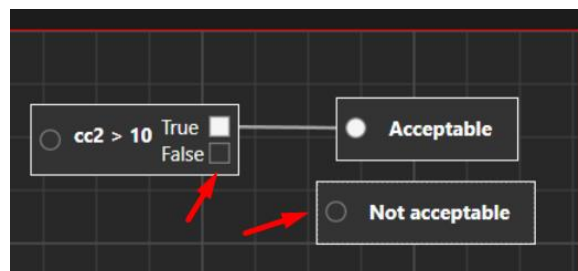
Obrázok 7.150 Podmienены uzol s pripojeným uzlom „Akceptovateľný“ výsledok
